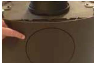
**6:** Soll der Ausgang hinten etabliert werden, muss der Gusseisenstutzen oben am Ofen abmontiert werden. Die Platten hinter der Außenklappe und dem Wärmeschild werden vorsichtig herausgebrochen. Die Abdeckplatte, die am Ofen montiert ist, wird abmontiert (muss durch die Brennkammer herausgenommen werden) und anschließend statt dem Gusseisenstutzen oben am Ofen montiert. Der Gusseisenstutzen wird hinten am Ofen montiert. Denken Sie an die Dichtung.
