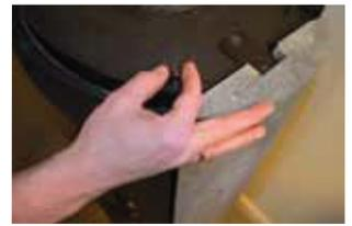
**4:** Montieren Sie die 4 oder 5 Spezialmuttern, die mit dem Heat-Storage-Kit mitgeliefert werden (Artikelnr. 08-423).
