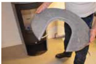
**22:** Montieren Sie den oberen Speckstein.
